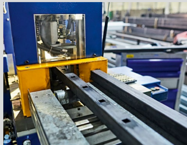
WYBIJANIE OTWORÓW W KSZTAŁTOWNIKU DO PRZĘŚLA TWORZONEGO W TECHNOLOGII PRZENIKANIA.
